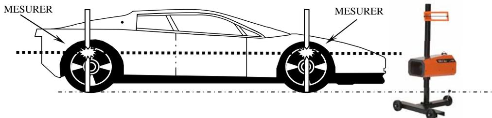
Aller au point central de la roue avant du véhicule et mesurer la distance du plancher jusqu'au point où le laser frappe la mesure du ruban: **ENREGISTRER.**
