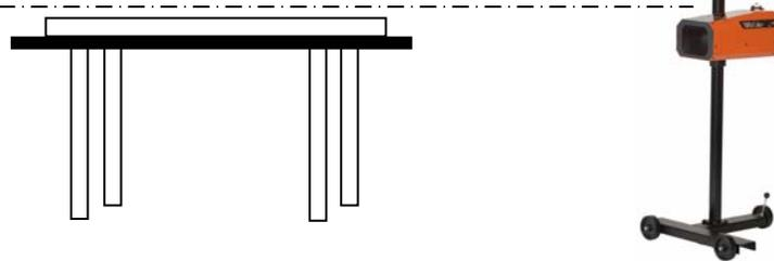
Ajuster la roue de pente du plancher arrière jusqu'à ce que le niveau de la tête optique soit centré. Il peut être nécessaire de réajuster la hauteur du bloc optique.
