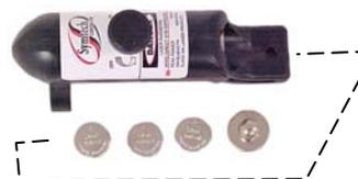
Dévisser le dos du laser et remplacer les piles par trois (3) piles de type bouton **LR 44** ou l'équivalent. Inverser le processus pour le montage.
