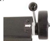
**NOTE:** En tournant l'axe excentrique du **BCA 4 ISOColor**, les deux mesures changeront aux roues avant et arrière du véhicule, pour atteindre des mesures égales, plus d'un changement d'axe excentrique peut être nécessaire.
